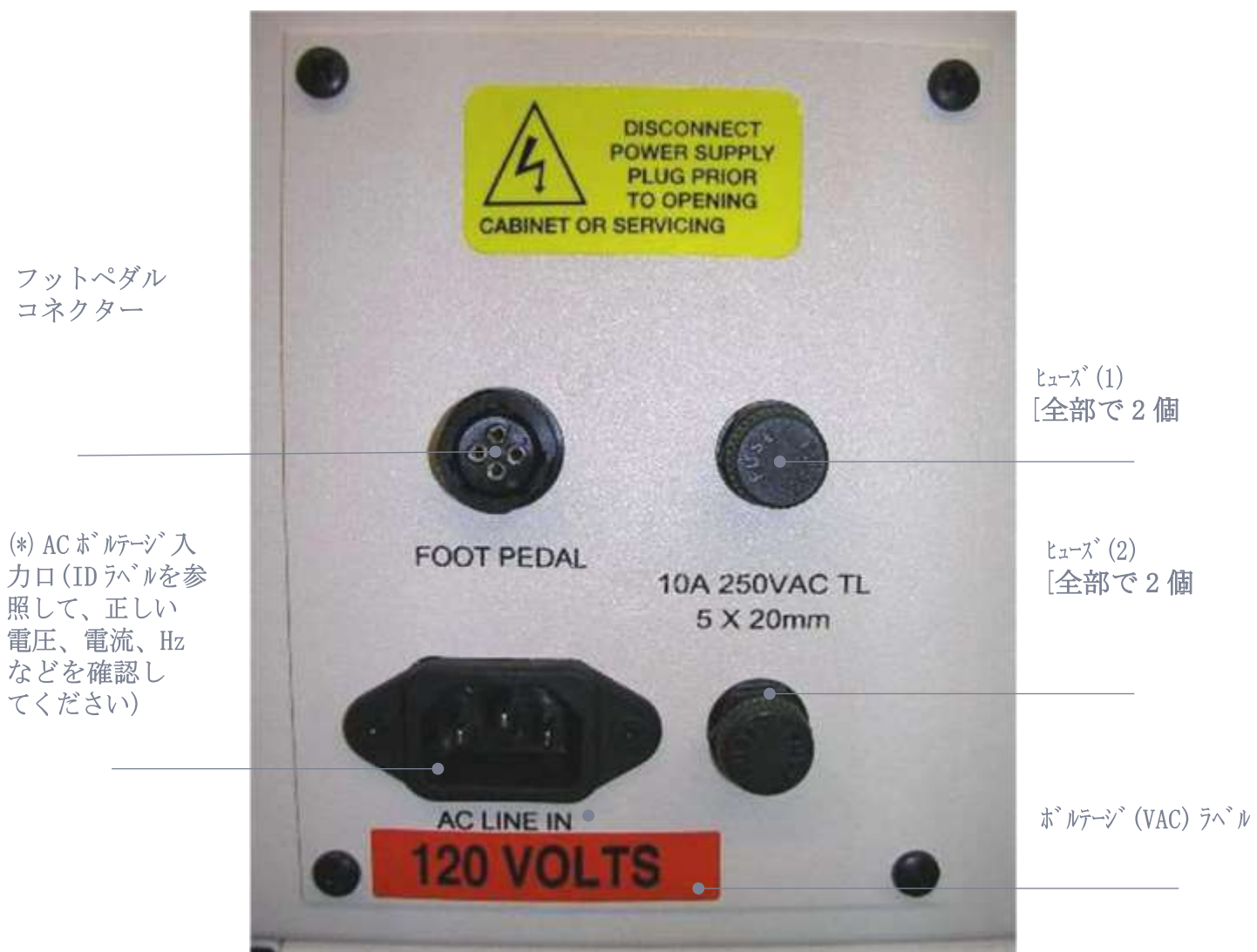
図 74 (メイン電源パネル)
