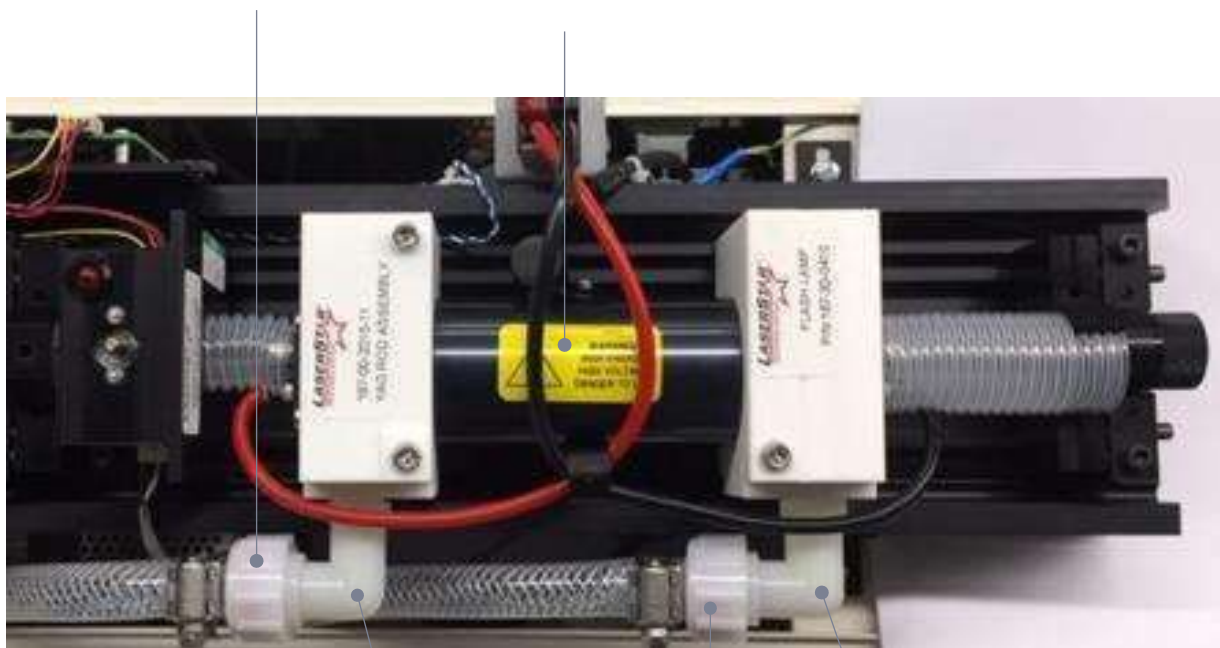
図 5 (ポンプチャンバーアッ センブリ[クーリングホ ースコネクション])
